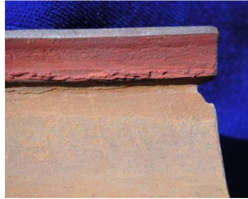
Hình Ăn mòn axit cacbonic trên ống hồi lưu nước ngưng (bên phải: ảnh phóng to).
