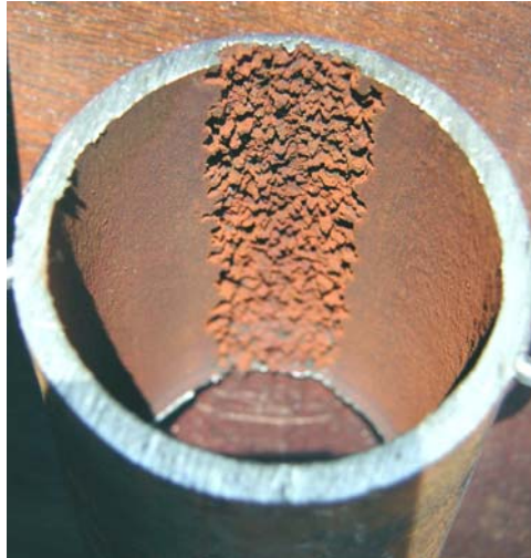
Hình 8. Ăn mòn xói mòn trên đỉnh ống (vị trí 12h) của ống ngưng hồi lưu.
