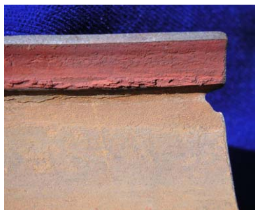
Hình 5 và 6. Ăn mòn axit cacbonic trên ống hơi lưu nước ngưng (bên phải: ảnh phóng to)
